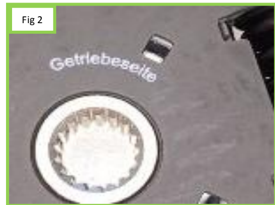
Getriebeseite (gearbox side) on the friction plate
